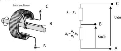
Les entrées analogiques convertissent un signal entre 0V et 5V en une valeur comprise entre 0 et 1023, avec pyFirmata entre 0 et 1. Le montage ci-contre propose un câblage d'un potentiomètre pour mesurer la variation de tension en fonction de la position du curseur.
